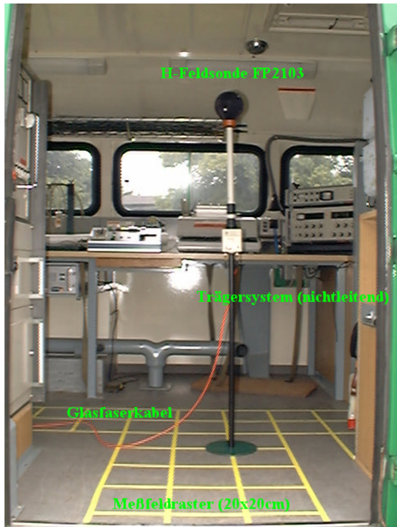
Bild 3 Meßaufbau zur Erfassung des Magnetischen Feldes
